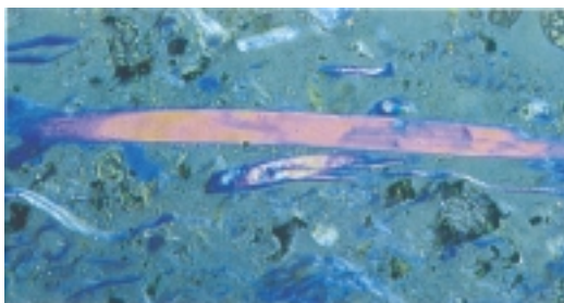
Syntetiske fibre og cellulosefibre i råmassen forstørret 260 gange.
